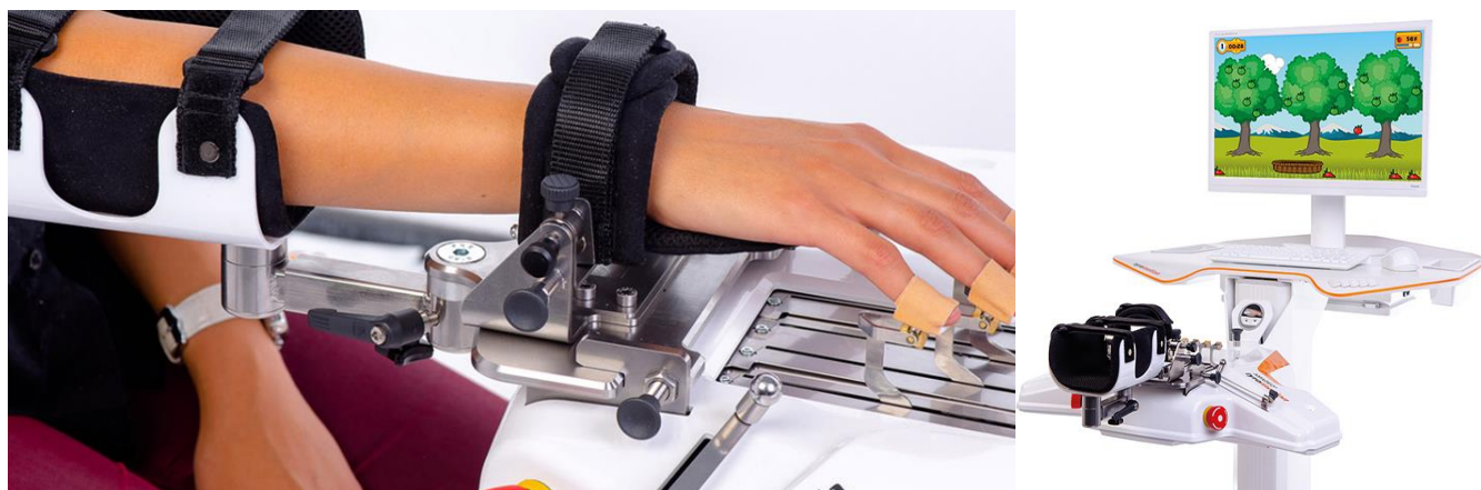
Рисунок 20 – Тренажёр для проведения роботизированной механотерапии «Амадео»
